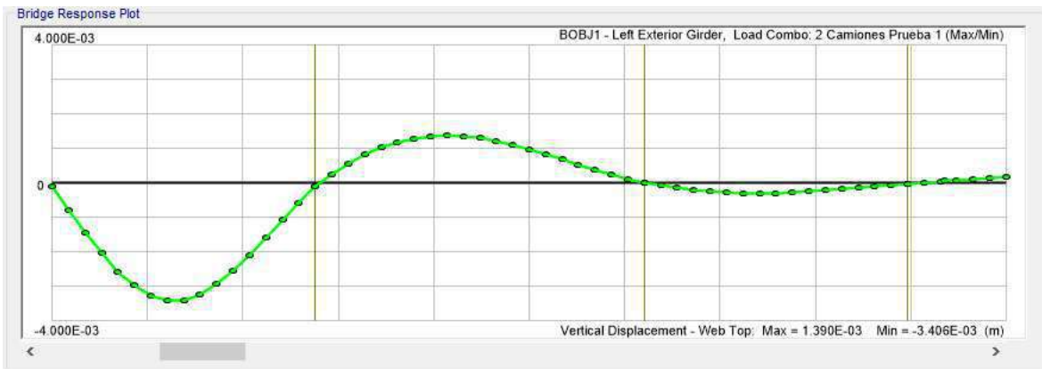
Imagen 18. – Deflexiones en Viga 1 por efecto de la carga, Prueba 1 – 2Camiones (P1C2) D = 3.41 mm.
