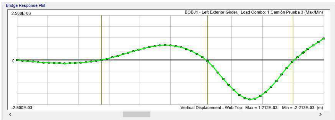
Imagen 30. – Deflexiones en Viga 1 por efecto de la carga, Prueba 3 – 1Camión (P3C1) D = 2.21 mm.
